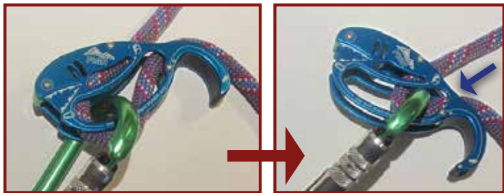
Werking van een autotuber (Fish van Austria Alpin)
