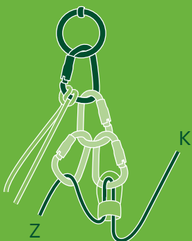
Zekeren met een 'voorgeschakelde' karabiner
